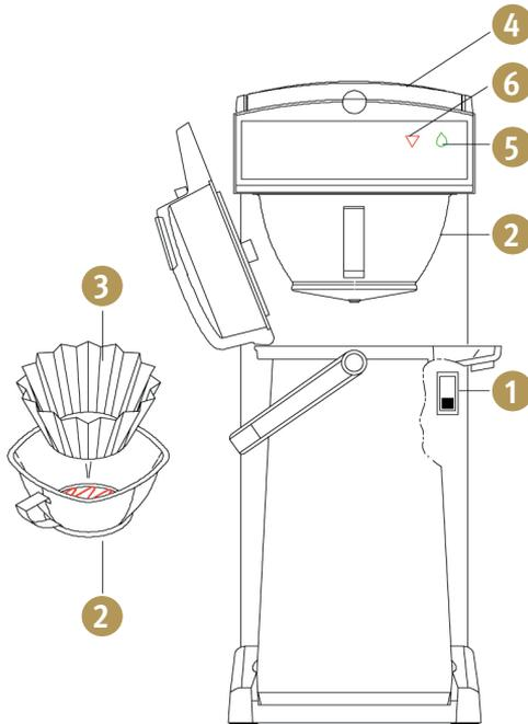
1. Ein/Aus-Schalter der Maschine
